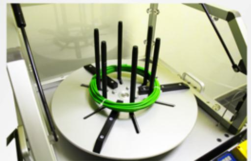
Kompakter Aufwickler für bereits abgelängte Leitungen.
